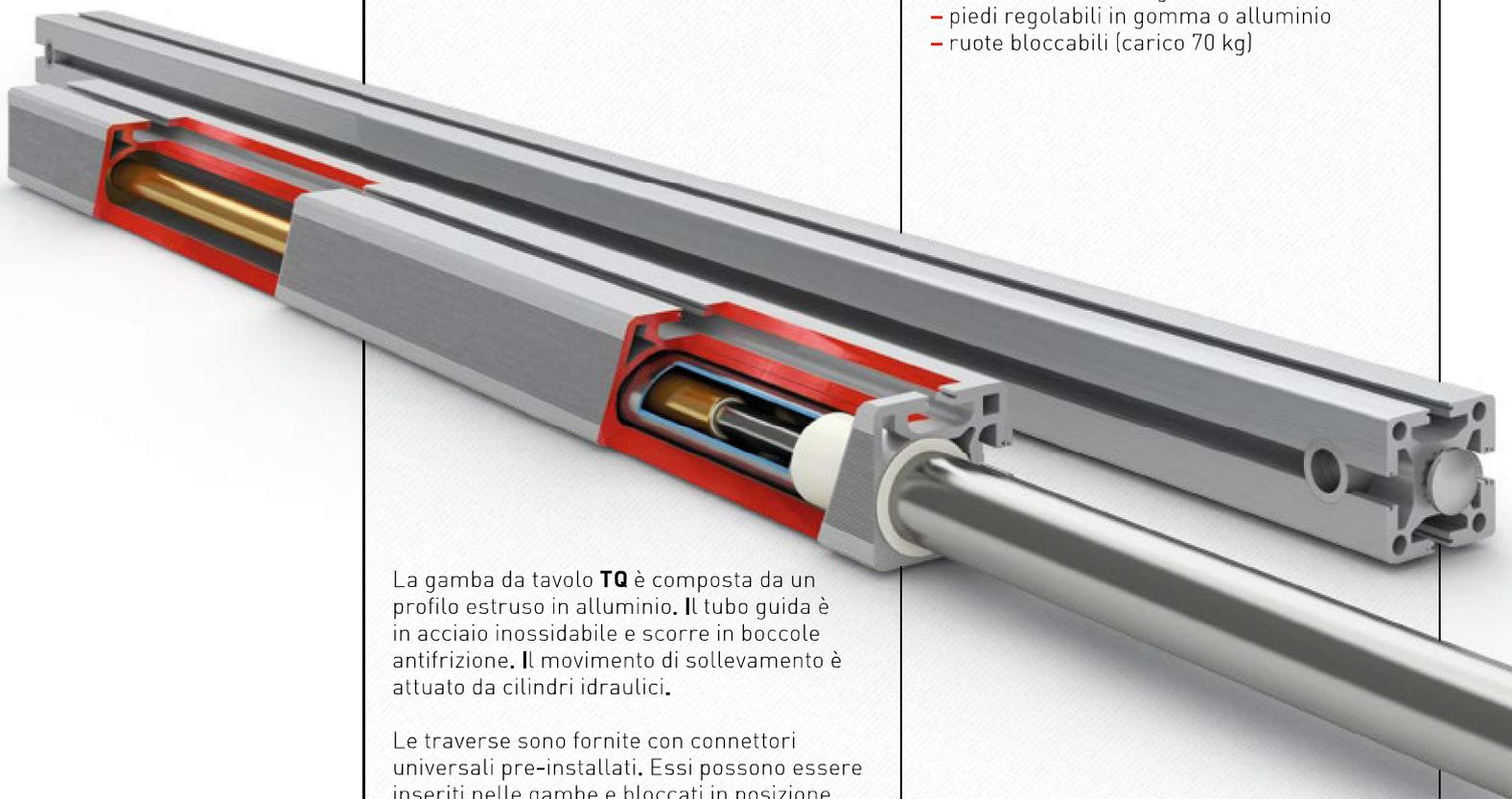
La gamba da tavolo **TQ** è composta da un profilo estruso in alluminio. Il tubo guida è in acciaio inossidabile e scorre in boccole antifrizione. Il movimento di sollevamento è attuato da cilindri idraulici.
